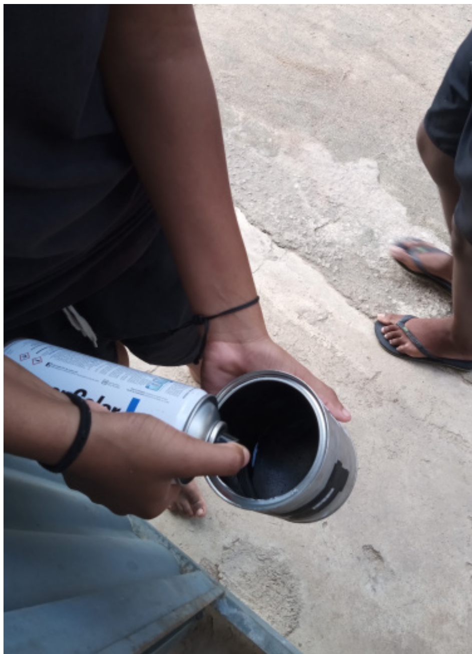
Escurecendo o interior da lata com tinta spray preta. Foto do autor.
