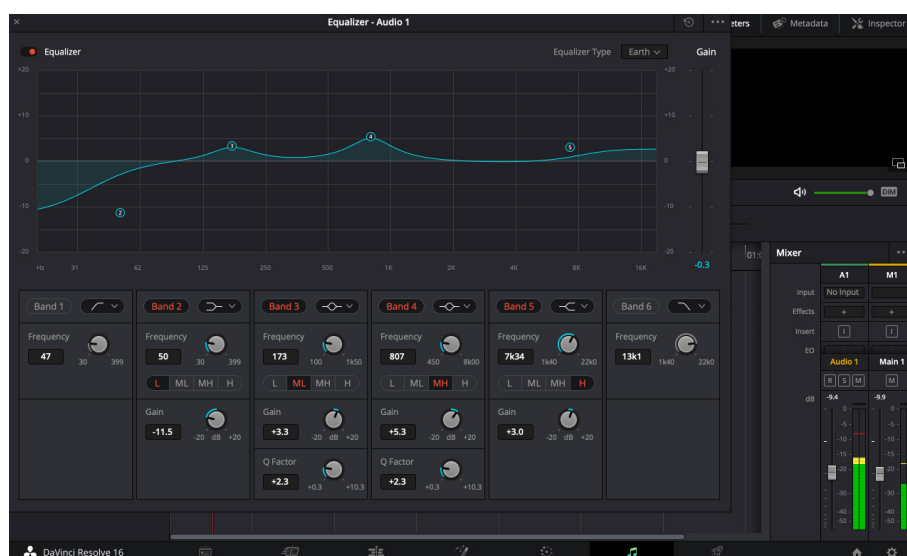
Figura 23. Controles de equalização do programa de edição Davinci Resolve. O programa oferece a manipulação de até 6 bandas de frequência. Na imagem, temos quatro bandas ativas: Band 2 (frequências baixas – L); Band 3 (frequências médio/baixas – ML); Band 4 (frequências médio/altas – MH); Band 5 (frequências altas – H). Fonte: DaVinci Resolve.
