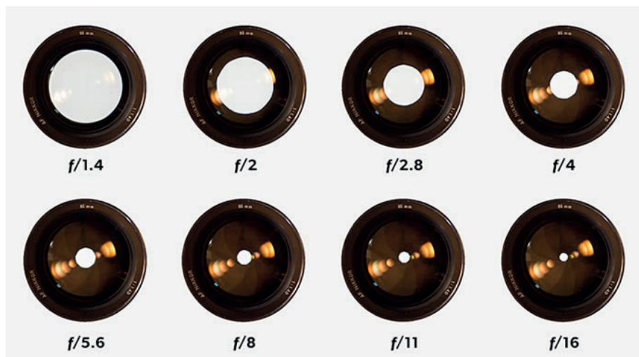
Figura 29 – exemplos de abertura de diafragma com seus respectivos valores.
